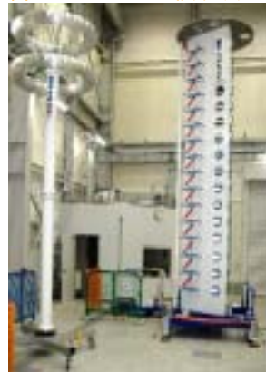
1600kV(160万V) 波形1.2 / 50 μs
