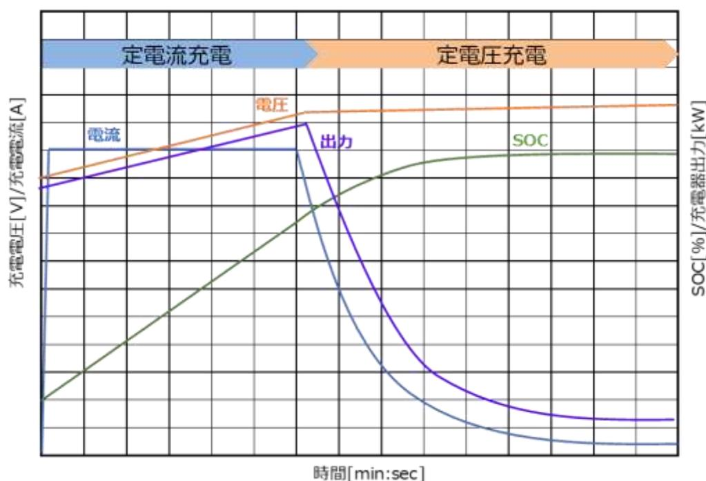
図 4-1 車両電池の充電特性(例)
