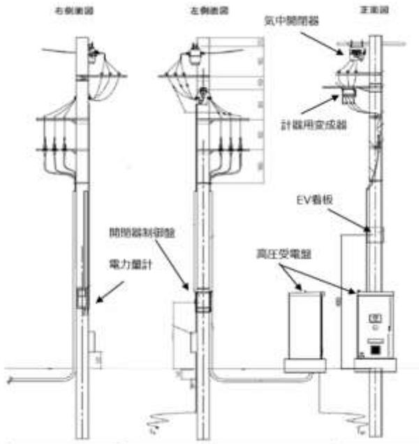
図 5-1-4.装柱図例
