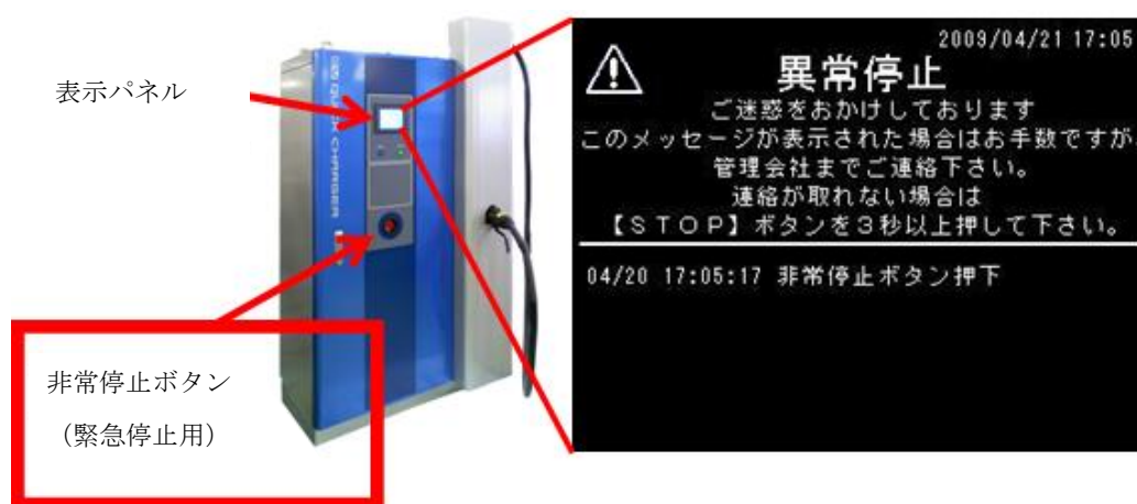
図 7-2-2 表示パネルにおける異常停止の表示例
