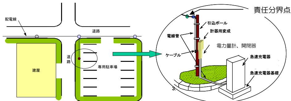
図3-1 急速充電器の低圧供給の一例
