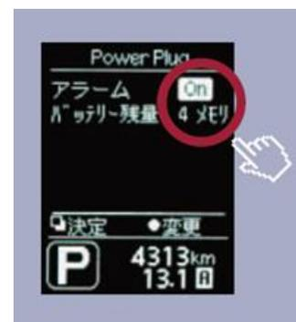
パワープラグ用バッテリー残量制限レベルの設定画面例
