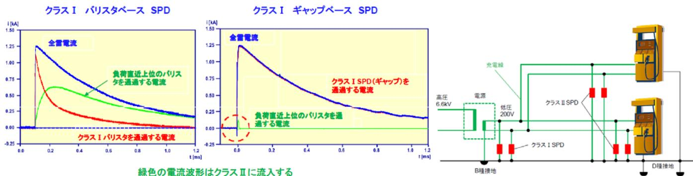
図12. 減結合インダクタンス10mにおける電流特性 (全電流:1.25kA 10/350 $\mu$ s)
