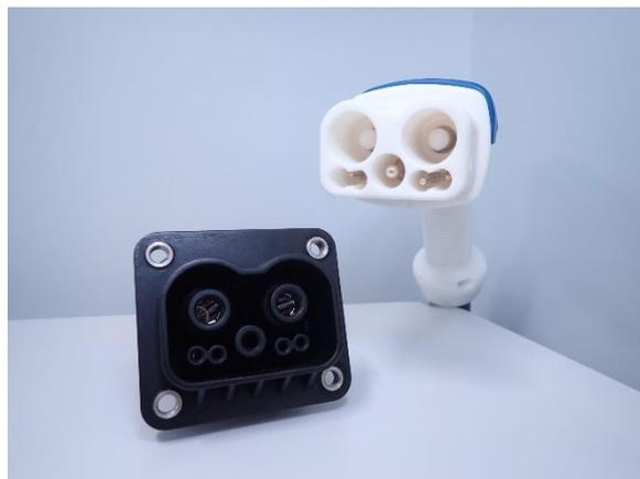
またChaoJi TWS SWG1で問題提議された大電流対応のため冷却構造を採用した端子の温度測定に関して、実モデルによる400A通電での温度測定を行い、結果を報告するとともに安全性確保のための提案を行いました。
