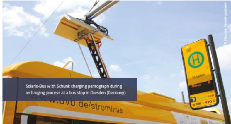
自動接続（パンタグラフ）充電のイメージ ACD (pantograph) charging image
