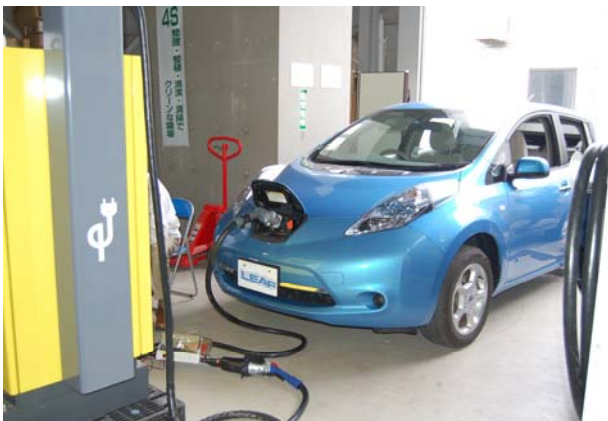
急速充電器とEVの接続試験
