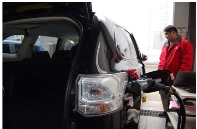
急速充電器とEVの接続試験
