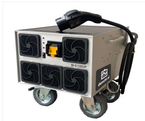
Bi-S.C002Pは、EVの急速充電ポートから微小放電することで、車載電池パックの診断を可能とするIoTデバイスです。付属のCHAdeMOコネクタをEVに挿入し、V2Lプロトコルの管理下で、車載電池パックのインピーダンス測定・内部状態の診断を数秒で行います。可搬式で電源コードレスの診断機であるため、その場で迅速にEVの電池診断を行うことができます。Bi-S.C002Pは、PC/スマートフォン/タブレット等、無線LAN通信に対応した各種端末から、操作・結果表示が可能です。ユーザー認証から診断レポート生成までのすべての作業は、診断クラウドサービス(denchi.aiTM)により提供されます。
