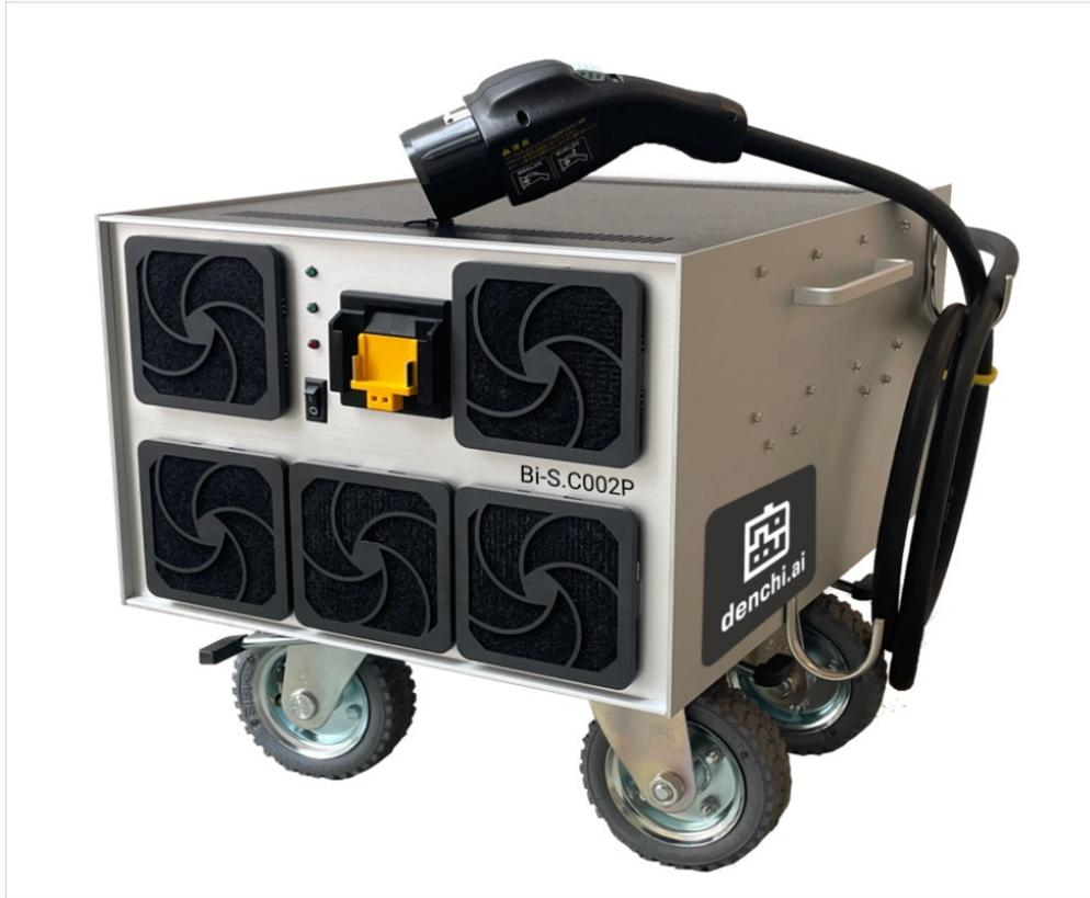
Bi-S.C002Pは、EVの急速充電ポートから微小放電することで、車載電池パックの診断を可能とするIoTデバイスです。付属のCHAdeMOコネクタをEVに挿入し、V2Lプロトコルの管理下で、車載電池パックのインピーダンス測定・内部状態の診断を数十秒で行います。可搬式で電源コードレスの診断機であるため、その場で迅速にEVの電池診断を行うことができます。
