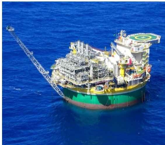
円筒形状の浮体構造物
