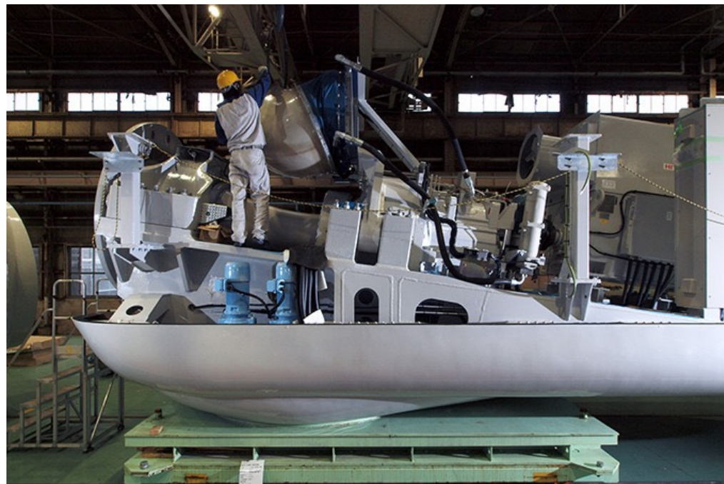
富士重工業宇都宮工場で組み立て中のナセル
