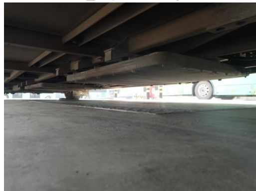
2台の車上コイルと地上コイル、コイル表面樹脂板の滑り止め模様
