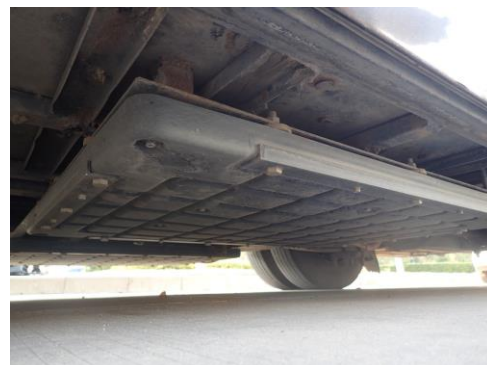
横2連の車上コイル、地上コイルと正着用ハンパ、コイルと電源盤の位置関係
