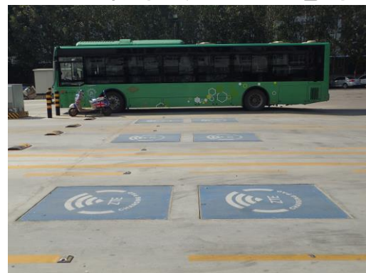
2台の車上コイルと地上コイル、コイル表面樹脂板の滑り止め模様
