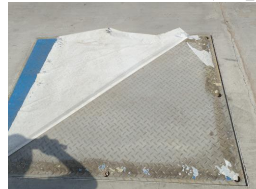
2台の車上コイルと地上コイル、コイル表面樹脂板の滑り止め模様
