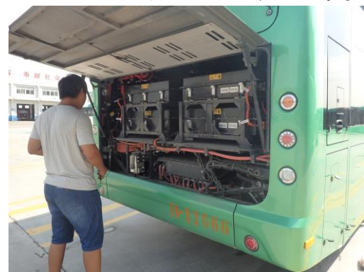
12kV/630kVAの高圧変電盤、電池の搭載状況と無線充電のエンブレム
