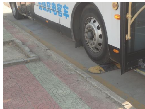
ハンパに正着したバス、出発時SOC47%で約23km走行後のSOCは34%
