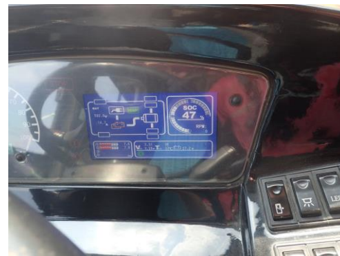
ハンパに正着したバス、出発時SOC47%で約23km走行後のSOCは34%
