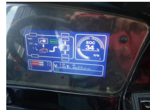
ハンパに正着したバス、出発時SOC47%で約23km走行後のSOCは34%
