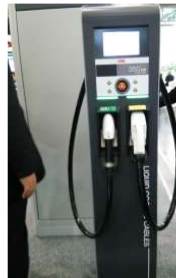
ABB(350kW) ※CCSのみ 液冷コネクタ：ITT Cannon 液冷ケーブル：Huber+Suhner
